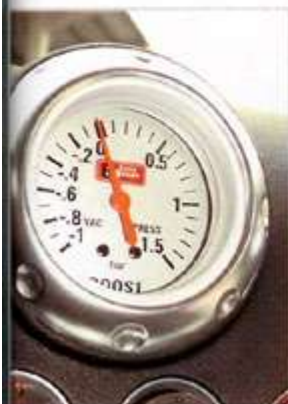
Die Ladedruckanzeige fand im Lüftungskanal Unterschlupf
