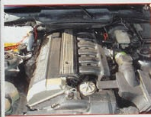
Nichts Neues: serienmäßiger M50-Reihensechszylinder mit 192 PS
