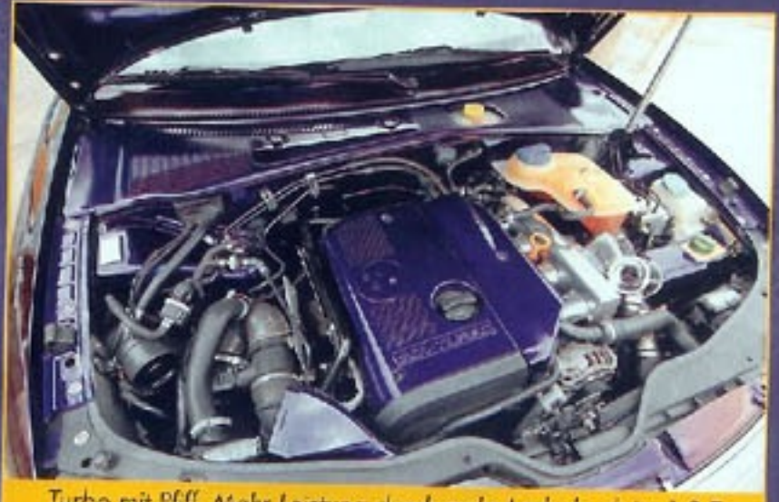
Turbo mit Pfiff. Mehr Leistung durch mehr Ladedruck im 1.8 T
