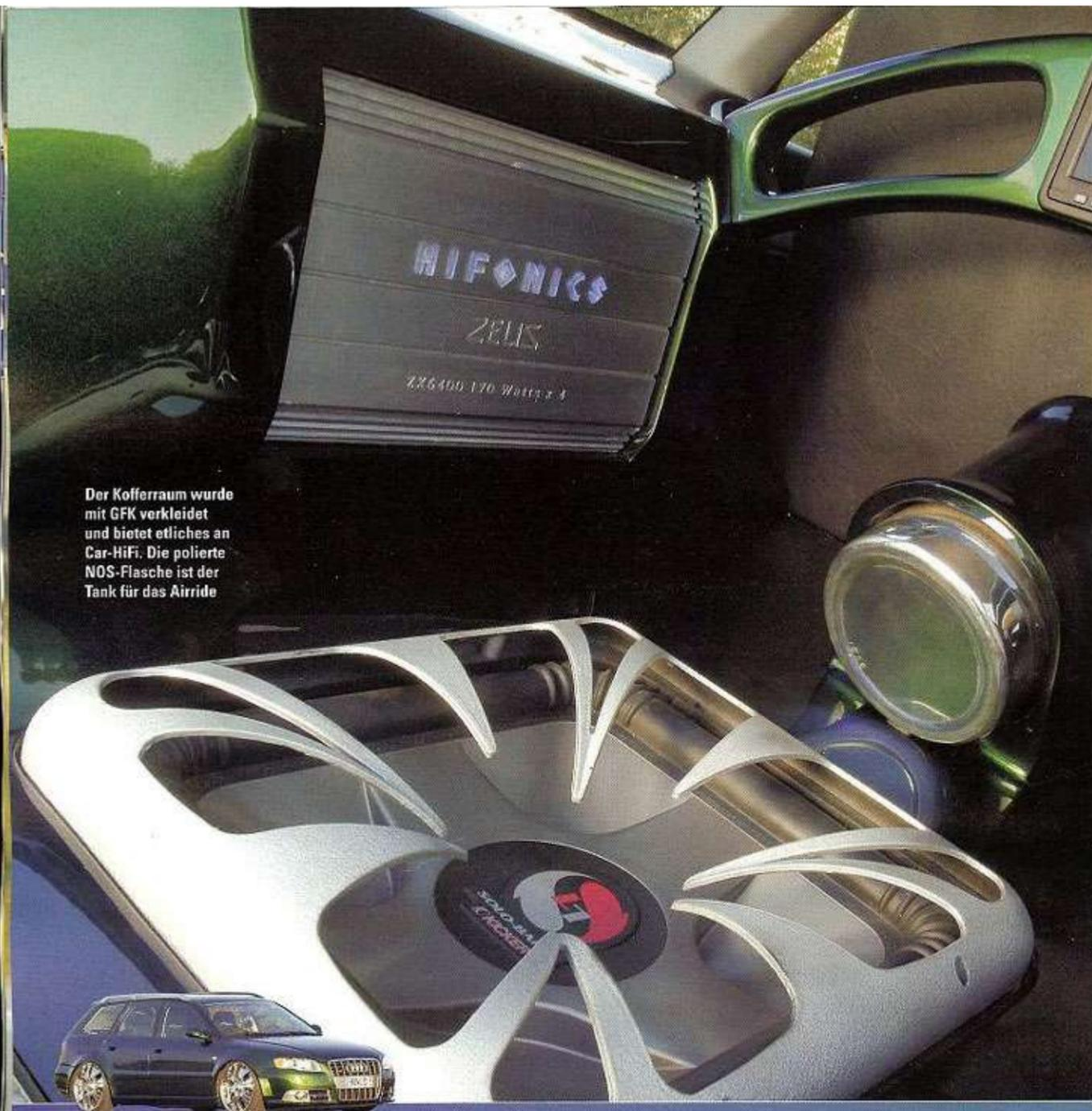
Der Kofferraum wurde mit GFK verkleidet und bietet etliches an Car-HiFi. Die polierte NOS-Flasche ist der Tank für das Airride
